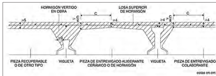
Fig. 3: condiciones geométricas de los forjados unidireccionales.
