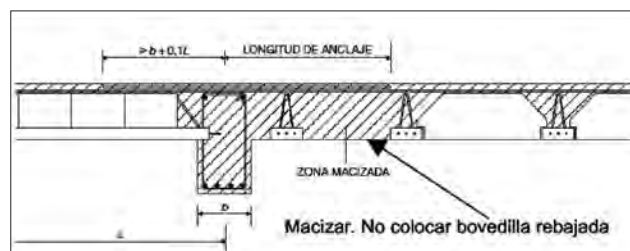
Fig. 5: encuentro entre forjados perpendiculares.
