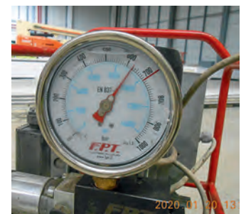
FIGURAS 1 Y 2 Equipo de trabajo y manómetro certificado de control de hincada.
