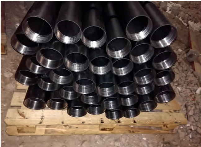
FIGURA 5 Tubería para micropilotes de diámetro 114,3 mm y espesor 8 mm.
