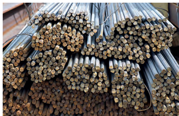
Figura 1: barras rectas de acero corrugado.
