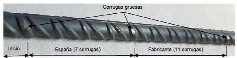
Figura 6: identificación del país y fabricante de una barra corrugada del diámetro 16.
